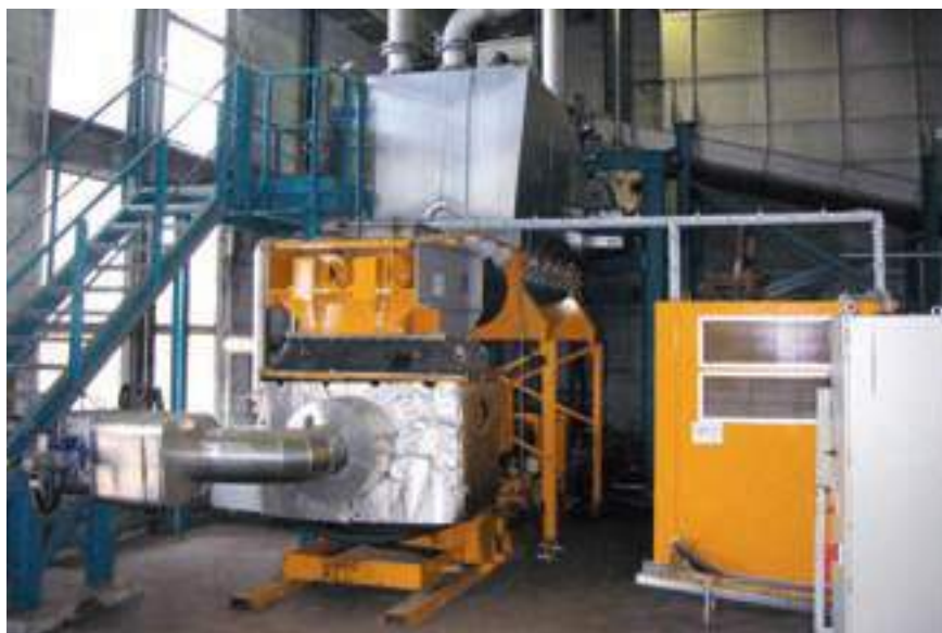
La KOS 2510 con grupo hidráulico y doble transportador de tornillo para transportar biomasa al depósito de fermentación
