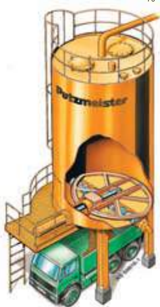
Silo de reserva con descarga a camión
