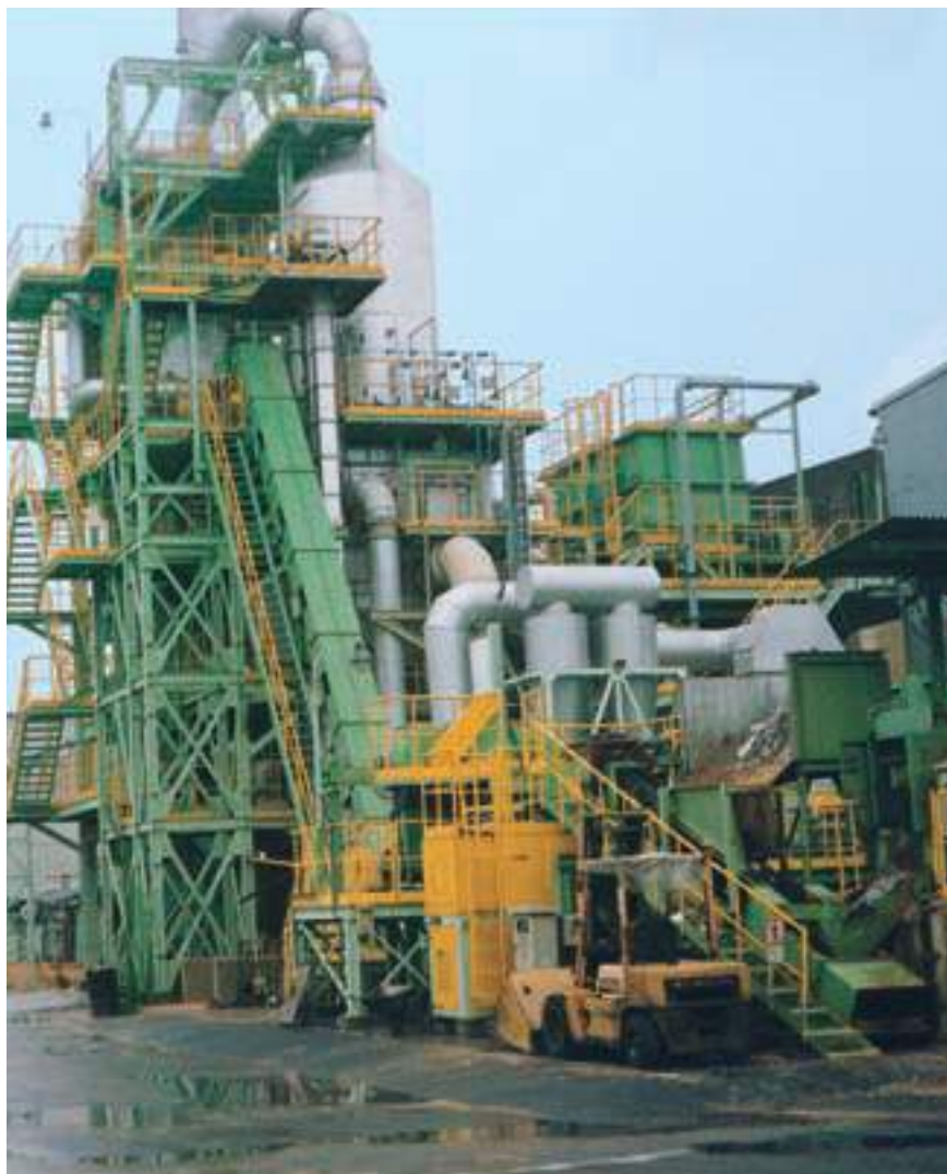
Bombas industriales KOS transportan lodo de papel al horno de tambor rotativo. Diariamente se producen 450 t de cartón procedente de papel usado.
