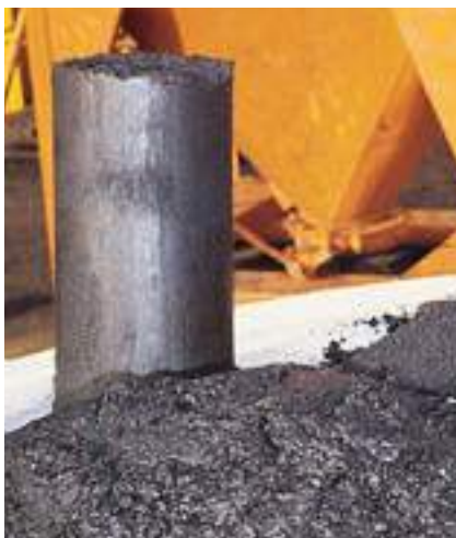
Carbón con contenido en materia seca de hasta el 85 %
