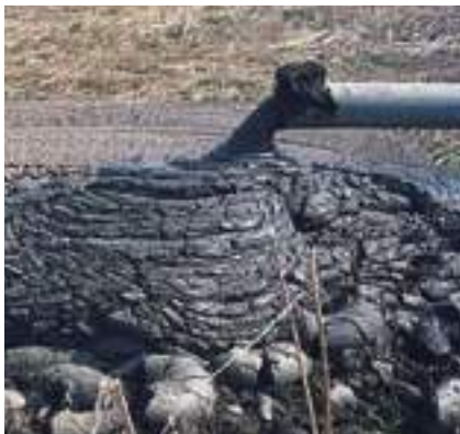
Lodo de río con alto contenido en materia seca, tiempos cortos de secado
