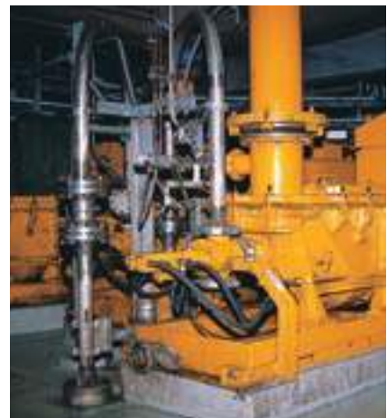
Bomba tipo KOS 1070 para la inyección de lodos de carbón
