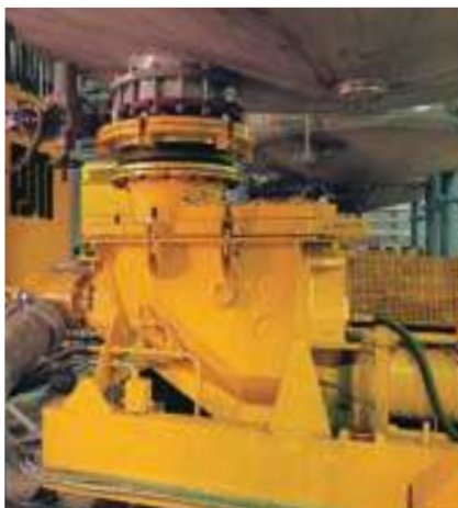
Bomba KOS 2180 para el transporte a distancia de carbón
