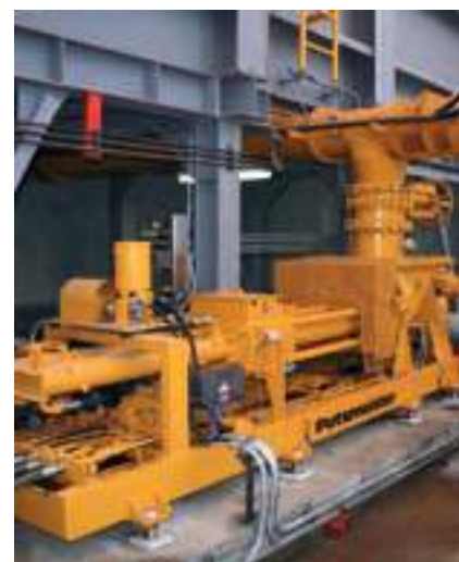
La KOS 1040 HP transporta diferentes tipos de lodos sobre una distancia de 100 – 150 m hasta los hornos de incineración (Siam City Cement, Tailandia).
