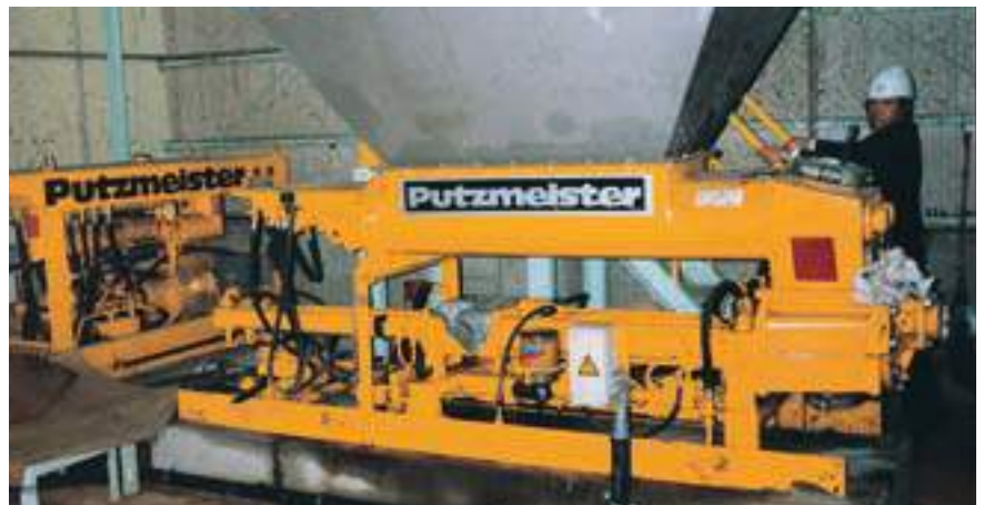
Una bomba industrial Putzmeister KOS 1030 transporta lodo de papel al horno de tambor rotativo
