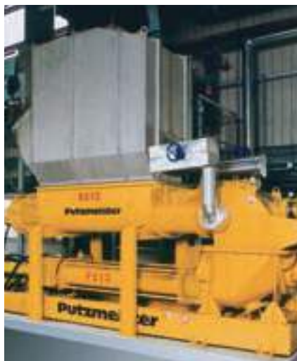
Instalación de reciclaje de basura orgánica en Varenne-Jarcy, Francia: la KOS 2180 bombea biomasa a una instalación de fermentación
