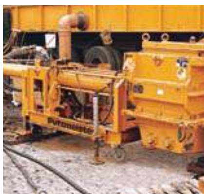
Estación móvil de bombeo y drenaje
