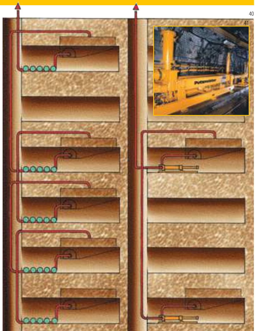
Instalación de elevación de lodos HBL. Antes: 43 bombas centrífugas. Ahora: 2 bombas industriales HSP 3080.
