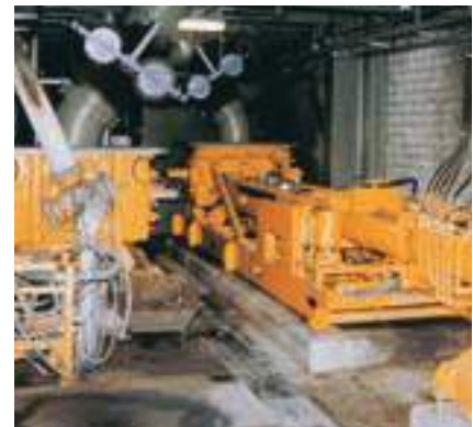
Bomba para relleno posterior KOS 3080 en la mina de Walsum (Alemania)
