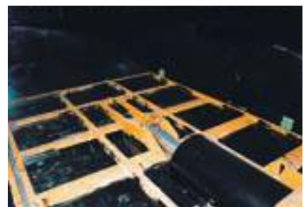
Bastidor deslizando de salida de silo rectángulo PDL
