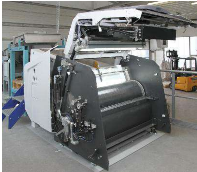
El nuevo clasificador MSORT con un práctico diseño y con puerta de inspección
