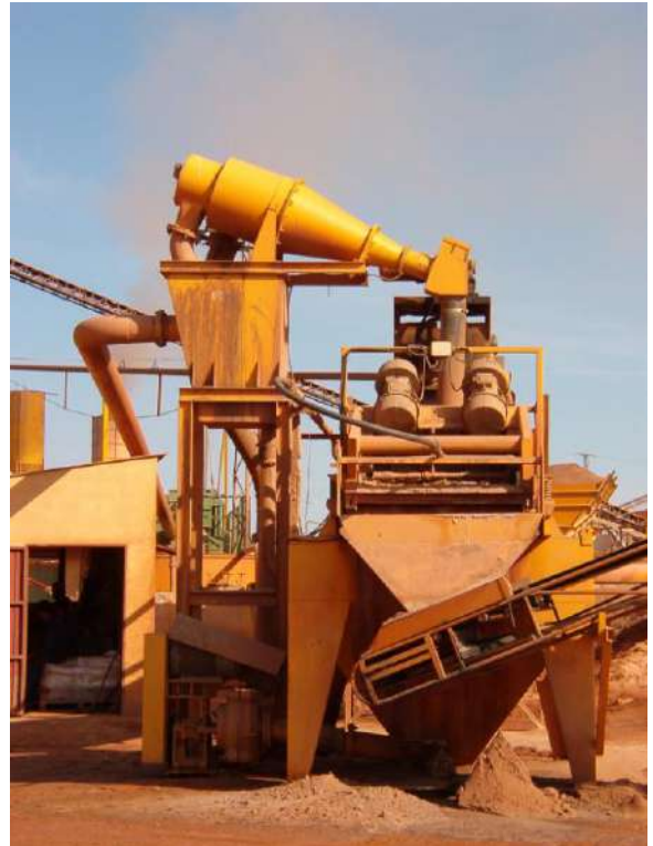
▲ RAF-250 con descarga a escurridor
