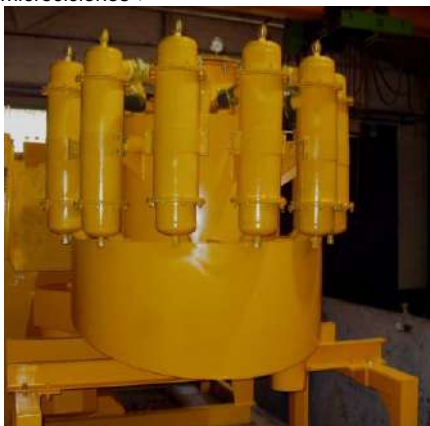
Segunda etapa de ciclonado con batería de microciclones▼
